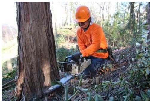
反対側に回り込み、くさびを打ち込みながら、慎重に切断してゆきます
