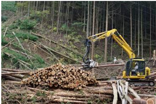
コンピューター制御で玉切りや枝払いをできる「プロセッサ」
