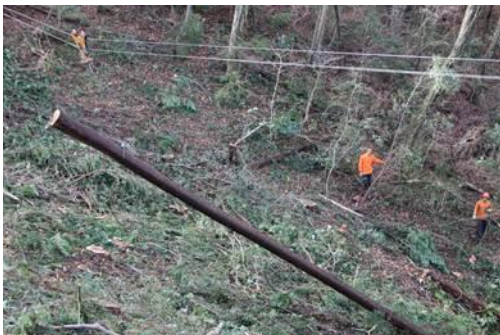
100m程度まで集材できる「スイングヤード」 材をワイヤーに固定後、無線で合図し集材します
