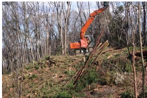
100m程度まで集材できる「スイングヤード」 材をワイヤーに固定後、無線で合図し集材します
